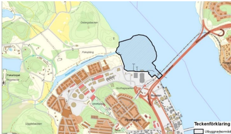
Figur 51. Översiktsbild över aktuellt utbyggnadsområde (Kolkajen-Ropsten) i Norra Djurgårdsstaden. Inom markerat område ska uppfyllnad, påldäck, övertäckning och muddring genomföras. Efter Sweco 2021.
